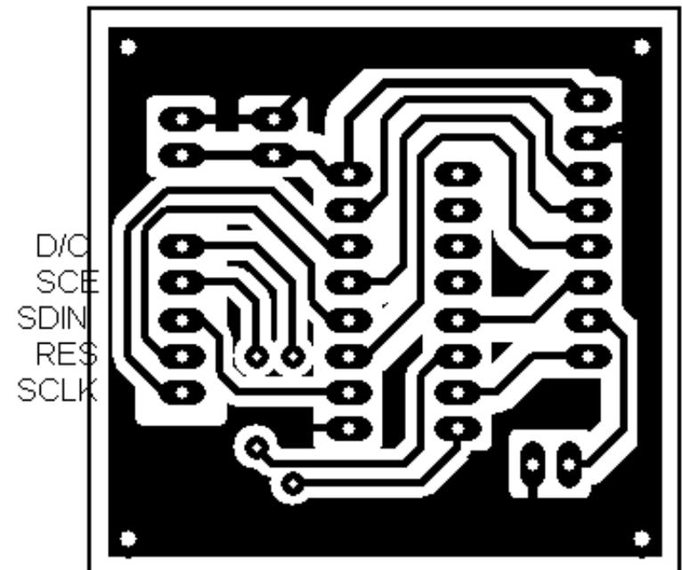
Cuando imprima ésta página haga los intentos necesarios hasta lograr que las distancias entre los pines del zócalo coincida con los 2'54m/m y entonces usted dispondrá del dibujo para realizar su PCB.
