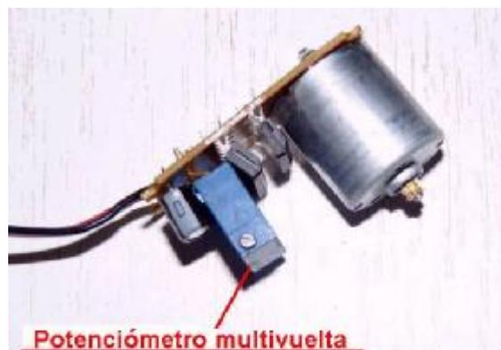
El inconveniente de utilizar este multivuelta, es que hay que practicar un taladro a la caja del servo para poder ajustar el “punto central o paro” del motor, con el potenciómetro. En la foto de abajo se puede apreciar el taladro en la caja del servo.
