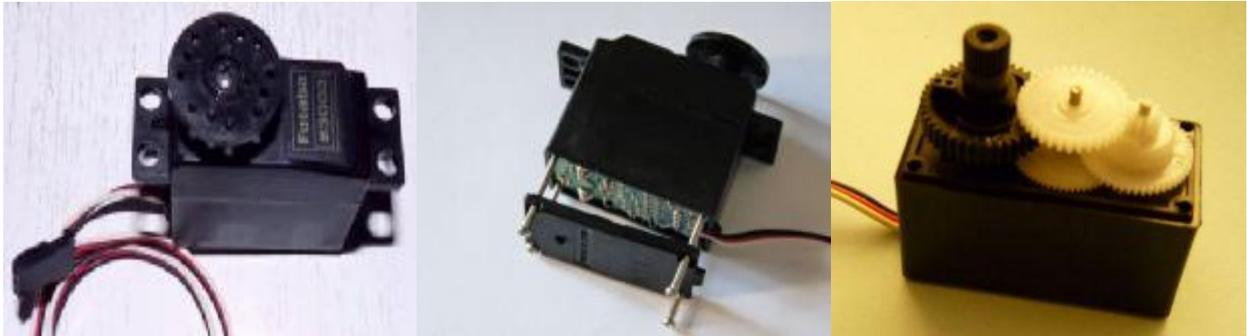
Pondremos especial atención a la posición de cada uno de los engranajes, ya que posteriormente los deberemos recolocar. A continuación extraeremos el engranaje de salida del servo, en la imagen de abajo, tenemos una foto que nos ayudará a recolocar más tarde los engranajes en la posición correcta.
