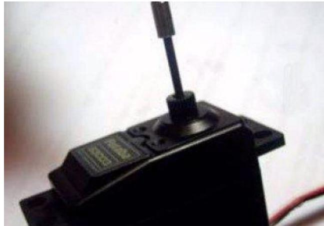
Sólo nos queda poner en marcha el prototipo para calibrarlo habrá que inyectarle una señal de 1'3 milisegundos y girando el destornillador, ajustar hasta que el servo se detenga, en ese momento tendremos calibrado nuestro servo. Veremos que en la medida que aumente o reduzca la frecuencia el motor del servo girara a un sentido u otro e irá incrementando la velocidad en la medida que nos aproximemos a los topes de frecuencia. Ya con esto, está listo nuestro servo trucado.
