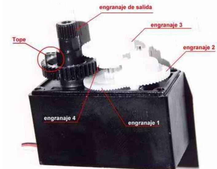
La parte mecánica del engranaje de salida, consistirá en cortar o limar el tope plástico del engranaje, de manera que no quede ninguna rebaba ni deformar los dientes del engranaje, en la imagen de abajo, un detalle comparativo de cómo deberá quedar el engranaje. Esto es todo por este apartado.
