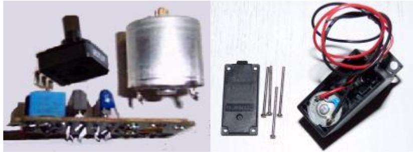
Para terminar, como se aprecia en la foto, volveremos a introducir el motor en la caja del servo, montamos la caja reductora en su sitio, cuidando de dejar cada engranaje en su sitio y cerraremos la caja tal y como estaban inicialmente. Podemos guiarnos con la foto de más arriba.
